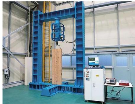
200kN 構造物試験装置
