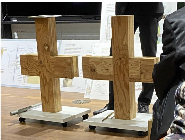
写真5 剛接合仕口ユニット模型
